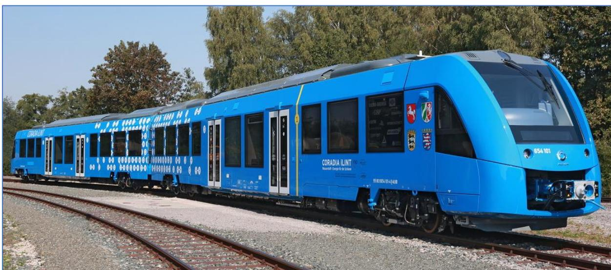
Новые электрички Coradia iLint должны заменить старые поезда на дизельном топливе и полностью убрать выбросы в атмосферу. Экологическая чистота водорода – относительна. Поезд не будет производить выбросов в движении. Однако общий углеродный след проекта будет зависеть от технологии получения водорода. При сегодняшней структуре производства электроэнергии в Германии и применении гидролиза для получения водорода проект по экологическим показателям проигрывает дизельному топливу.
