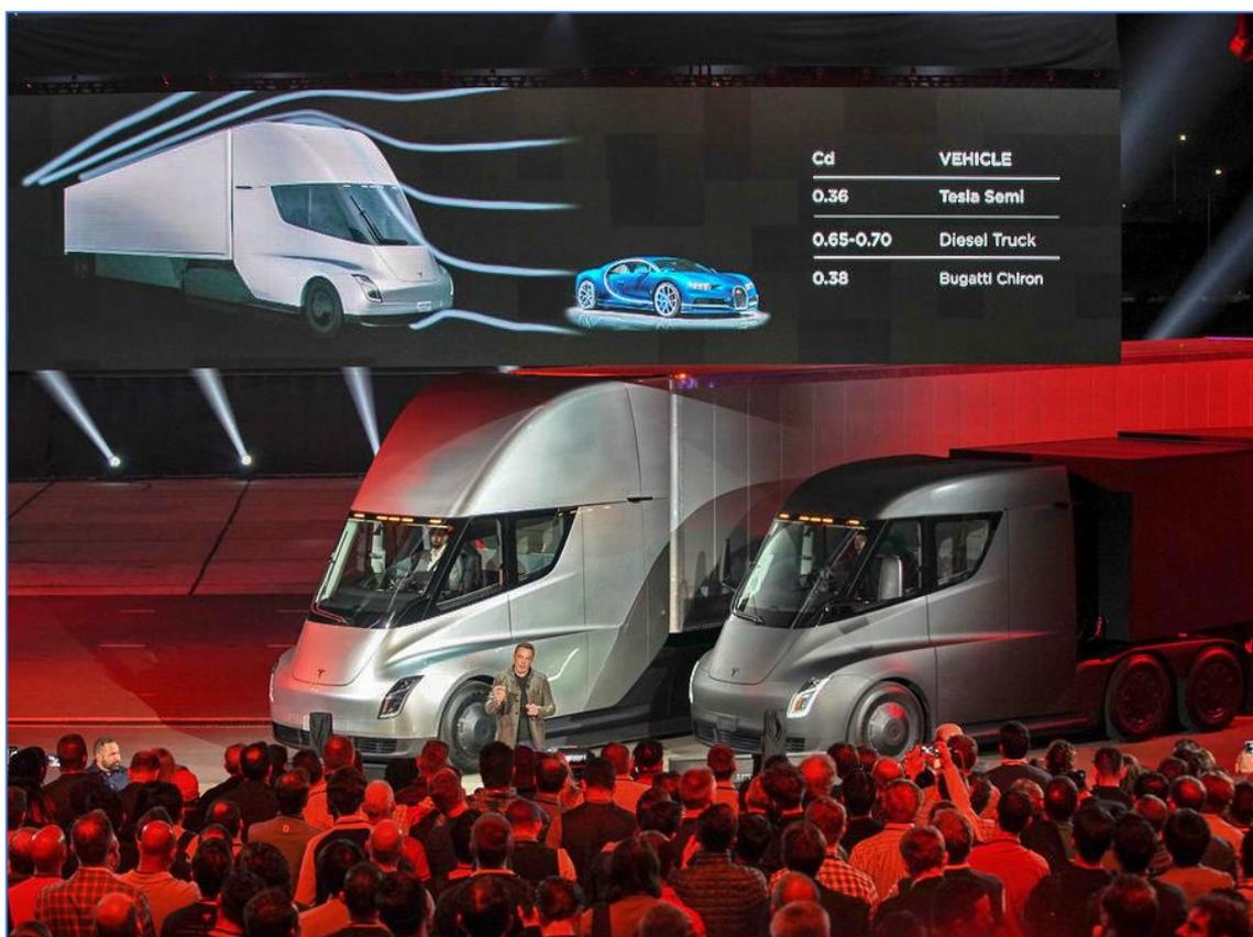
По утверждению Гийена, коэффициент аэродинамического лобового сопротивления электрогрузовика (0,36) даже меньше чем у скоростного болида Bugatti Chiron (0,38), не говоря уже о традиционном дизельном грузовике (0,65 – 0,70).
