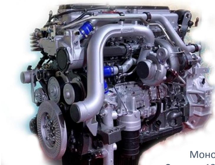
Прообраз нынешней разработки опытный рядный 6-цилиндровый двигатель объемом 12,9 л с искровым зажиганием Cursor 13 NG мощностью 460 лс на 2000 об/мин был показан в 2017 году. Выбросы двигателя соответствуют нормам Евро-IV. В 2018 году продемонстрирована следующая итерация прототипа.
