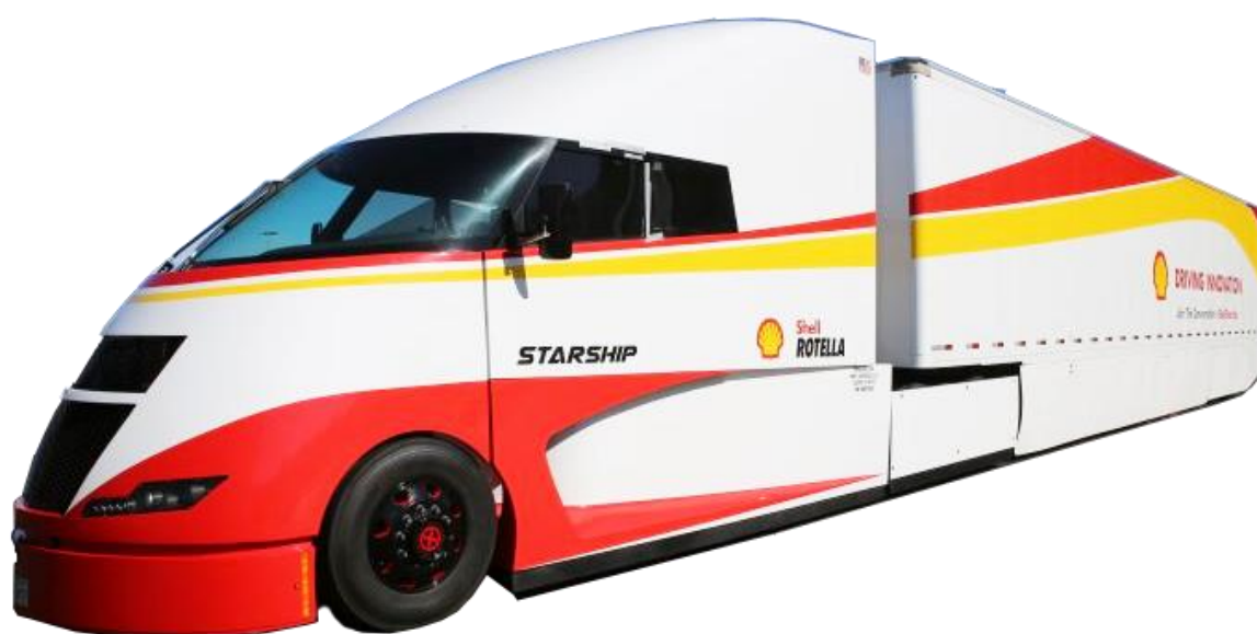
Экспериментальный магистральный грузовик компании Shell Global на солнечных батареях (5000 Вт) AirFlow Starship.
