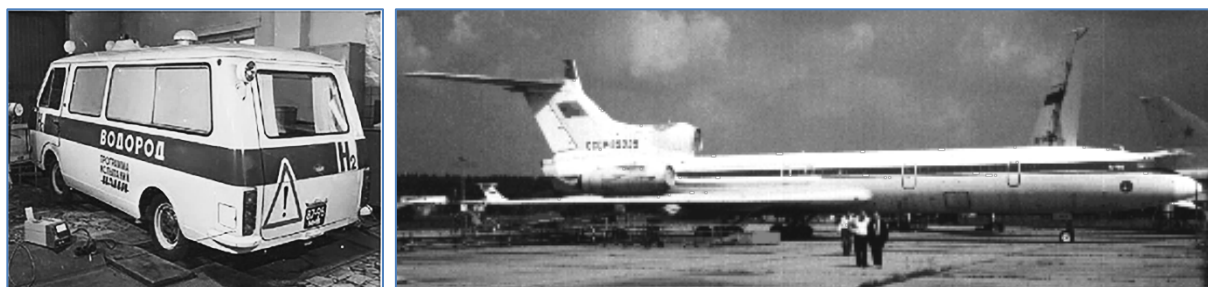
Рисунок 8: Бензоводородный РАФ-22034, самолет ТУ-155
