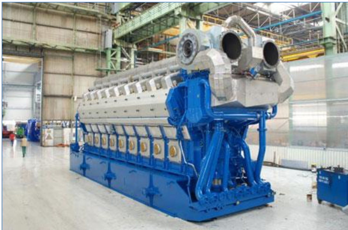
Основной газодизельный двигатель Wärtsilä для парома Megastar
