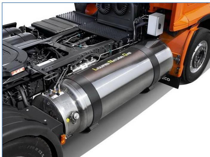
Разработчики делают отдельный акцент на экологических преимуществах нового газового тягача перед дизельным аналогом: выбросы частиц при использовании сокращены на 95%, CO – на 35%; уровень шума снижен на 5 дБ.
